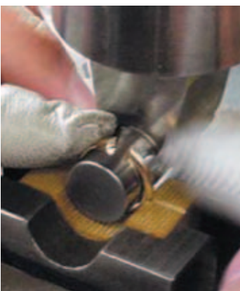
Рис. 18. Типичная установка для сгибания кольца
