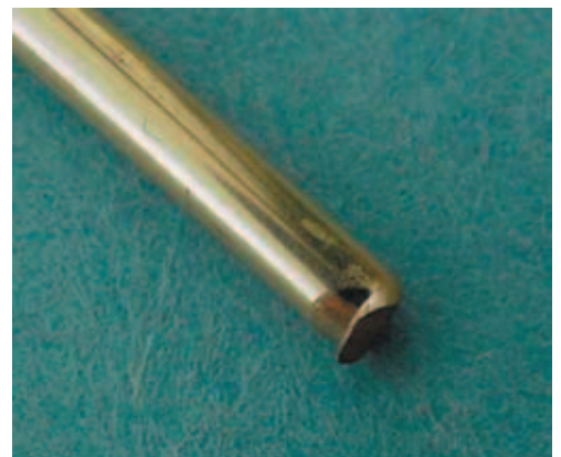
Рис. 14. Деформированная заготовка проволочного обода
