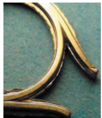
Рис. 21. Отметка от стружки на поверхности штамповки
