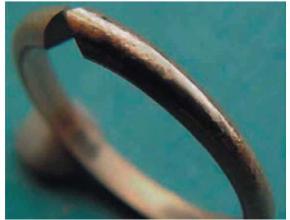
Рис. 11. Текстура «апельсиновая корка» на поверхности обода
