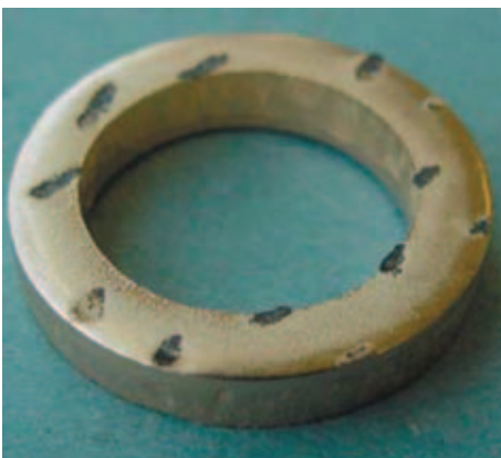
Рис. 12. Частично расплавленная поверхность
