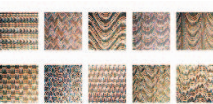
Рис. 4. Образцы резьбы, полученные единственным комплектом «прямой шаблон — копир» при смене параметров резки
