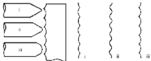
Рис. 5. Зависимость профиля вырезанной канавки от формы копира для одинакового шаблона
