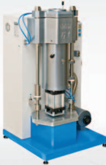
Индукционно-вакуумная литейная машина с электронным управлением G1 PLUS. GALLONI
