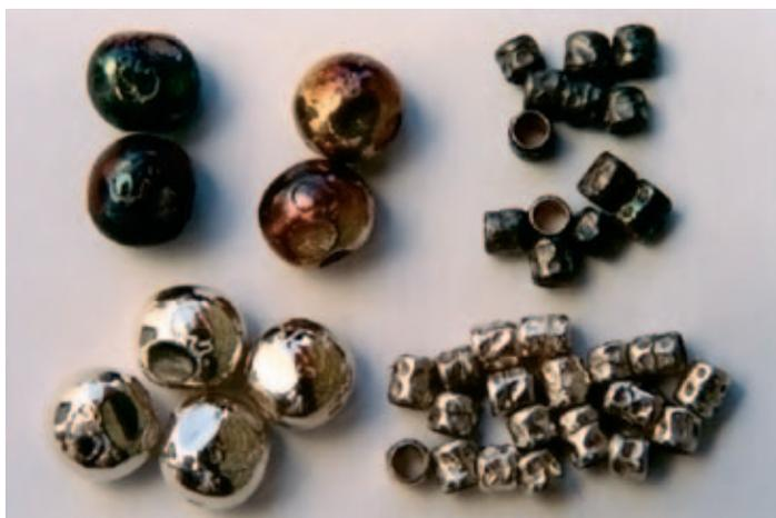
Рис. 3. Серебряные слитки и гранулы с различной степенью потемнения в сравнении со свежими слитками и гранулами
