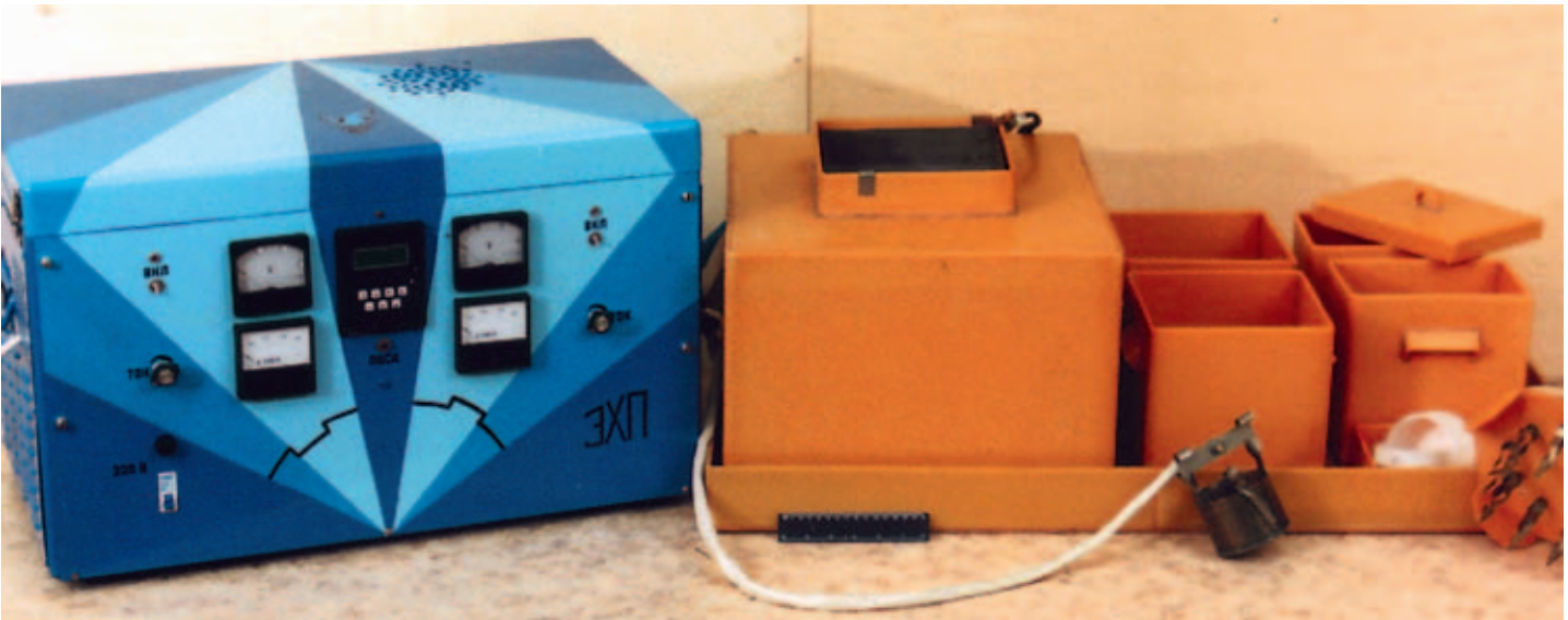
Установка для электрохимического полирования поверхности ювелирных изделий биполярными импульсами тока
