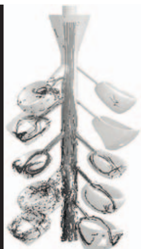
Рис. 20. Смоделированная турбулентность потока расплава в процессе заполнения, визуализированная так называемыми «мечеными» (изотопными) частицами
