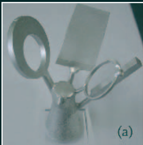
Рис. 2. Елка, изготовленная из сплава с раскислителем (a) и из сплава без раскислителя (b)
