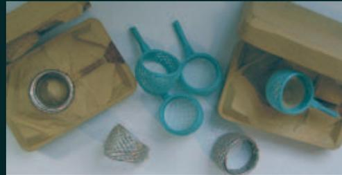
Рис. 21. Вулканизованные формы и шаблоны
