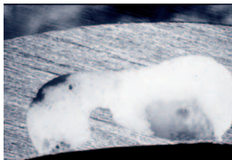
Рис. 12. Включение формомассы. Из «Справочника по дефектам литья и иным порокам ювелирных изделий из золота» Дитера Отта
