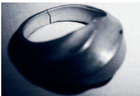
Рис. 1. Трещина от горячего надрыва в месте крепления литника к шинке
