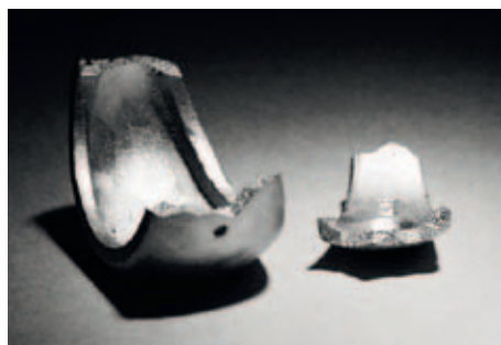
Рис. 2. Трещины от теплового удара
