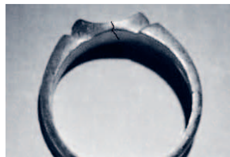
Рис. 3. Трещина из-за окисления на лицевой поверхности потока
