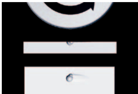
Рис. 11. Хвост кометы из мягких включений. Полировальный круг, попадая в «дырку», начинает краем вращаться быстрее и пропахивает борозду, по форме напоминающую хвост кометы
