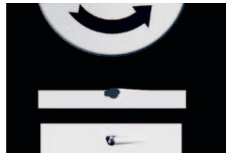
Рис. 5. Хвост кометы от твёрдого включения. «Холмик» металла, образовавшийся с подветренной стороны, выглядит, как хвост кометы
