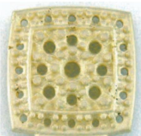
Рис.3. Модель, полученная на светоотверждаемом полимере с разрешением 25 мкм, отлитая в белом золоте 14К по стандартной технологии. Видны следы золы от сгоревшего материала. Уровень качества поверхности очевиден
