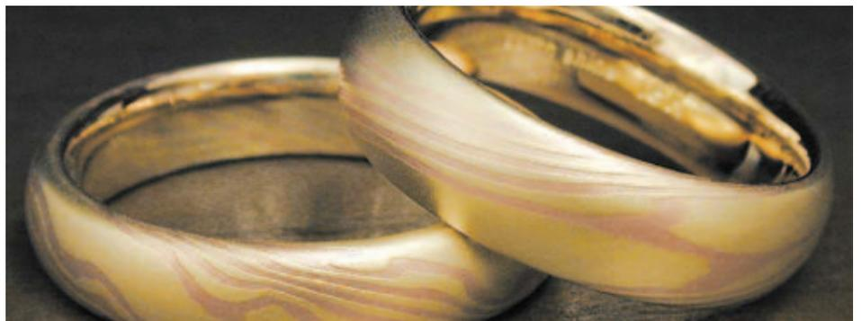
Белое палладиевое золото 583-й и 750-й пробы имеет более насыщенный серый оттенок, чем обычное никелевое белое золото, и является более дорогим материалом, но лёгкость его обработки оправдывает дополнительные вложения. Палладиевый сплав — самый тёмный из всех белых металлов, поэтому его можно использовать в контрасте с серебром, чтобы получить красивое сочетание белого на белом.
