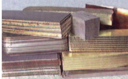
Сварку брикета мокуме можно проводить при помощи различного оборудования. Это может быть самая простая ювелирная горелка, самодельная мини-печь, изготовленная из двух огнеупорных кирпичей, где источником тепла является газовая горелка, кузнечный горн или электропечь с цифровым контролем температуры. Выбор оборудования зависит от способа соединения металлов. Для изготовления мокуме путём пайки припоем будет достаточно горелки, которой вы пользуетесь ежедневно.
