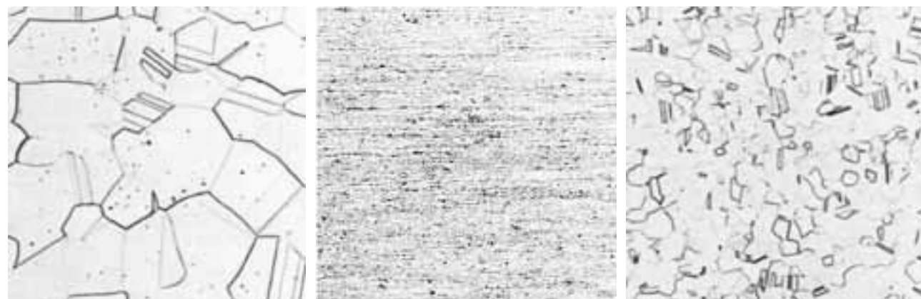
Рис. 6. Мелкозернистая структура после отжига рекристаллизации
