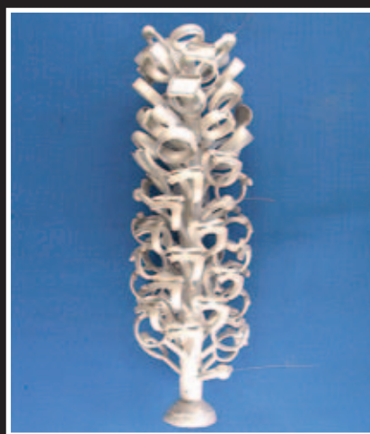
Рис. 1. Литая производственная елка одного из участников проекта; опытная форма добавлена к верхней, средней и нижней секциям
