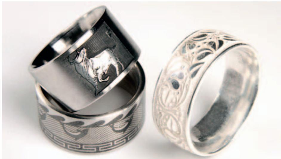
Как частный случай маркировки можно отметить снятие поверхностной краски на изделиях с нанесенным поверхностным слоем. Таким образом, надпись/маркировка получает изначальный цвет материала. На металлических поверхностях также возможна оксидная маркировка: металлы, разогреты до определенной температуры, в результате процесса окисления на поверхности получают цветное покрытие. На стали, например, популярностью пользуется придание голубоватого оттенка.
