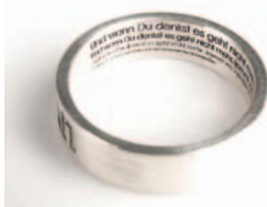
нанесение надписей или маркировок на поверхность изделия с помощью мощного лазерного луча. В отличие от лазерного давления при лазерной маркировке происходит изменение поверхности обрабатываемого изделия. Сам процесс маркировки и энергетическая мощность зависят от материала поверхности изделия. Лазерная маркировка — быстрый автоматизированный процесс, приспособленный к свойствам материала на поверхности изделия.
