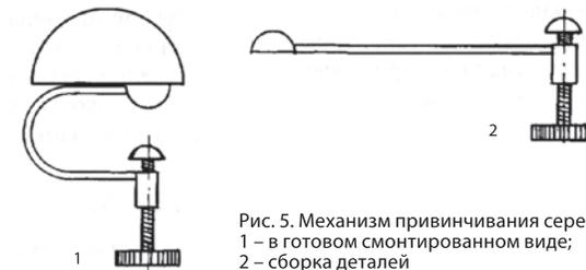
Рис. 5. Механизм привинчивания серег: 1 – в готовом смонтированном виде; 2 – сборка деталей
